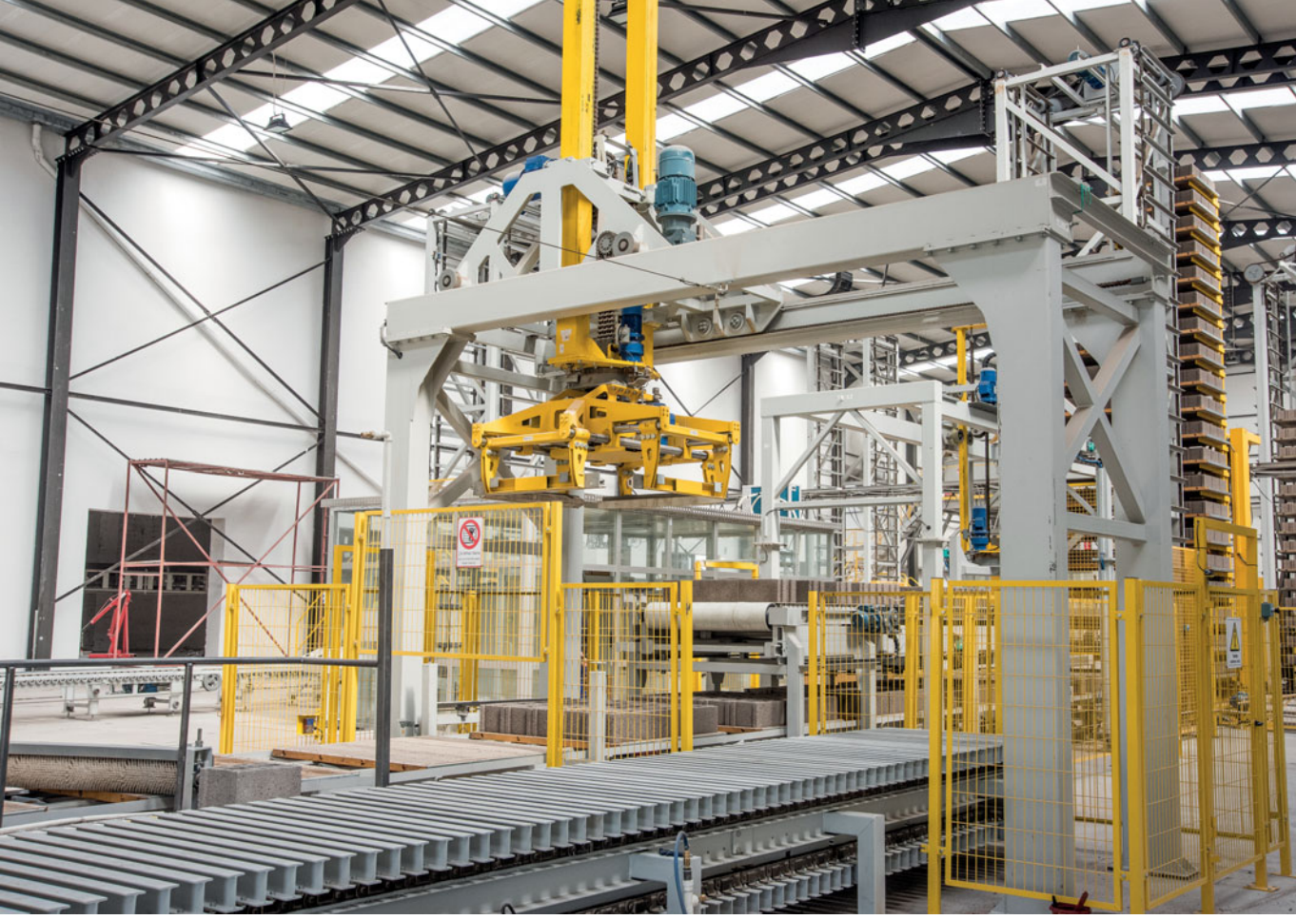
Elektromekanik kumandalı otomatik paketleme tesisi. Taşıma için boşlukların oluşturulduğu ve son katın çevrilmesi için çevirme mekanizmasının yer aldığı otomatik ön paketleme istasyonu
