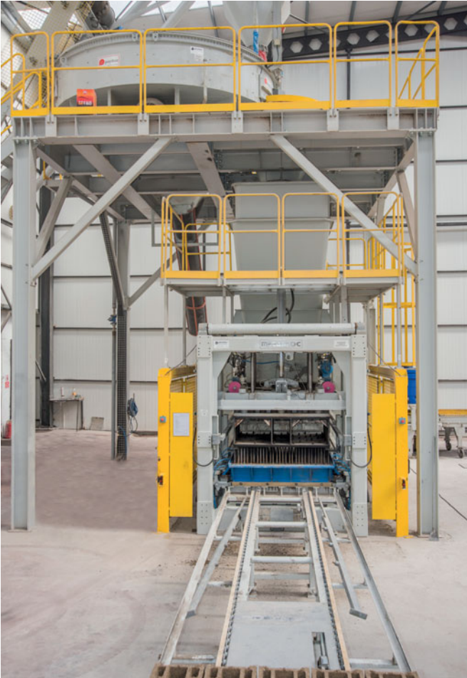
Yakl. 15 saniye süren her bir üretim çevriminde 18 adet beton blok üretilir.
