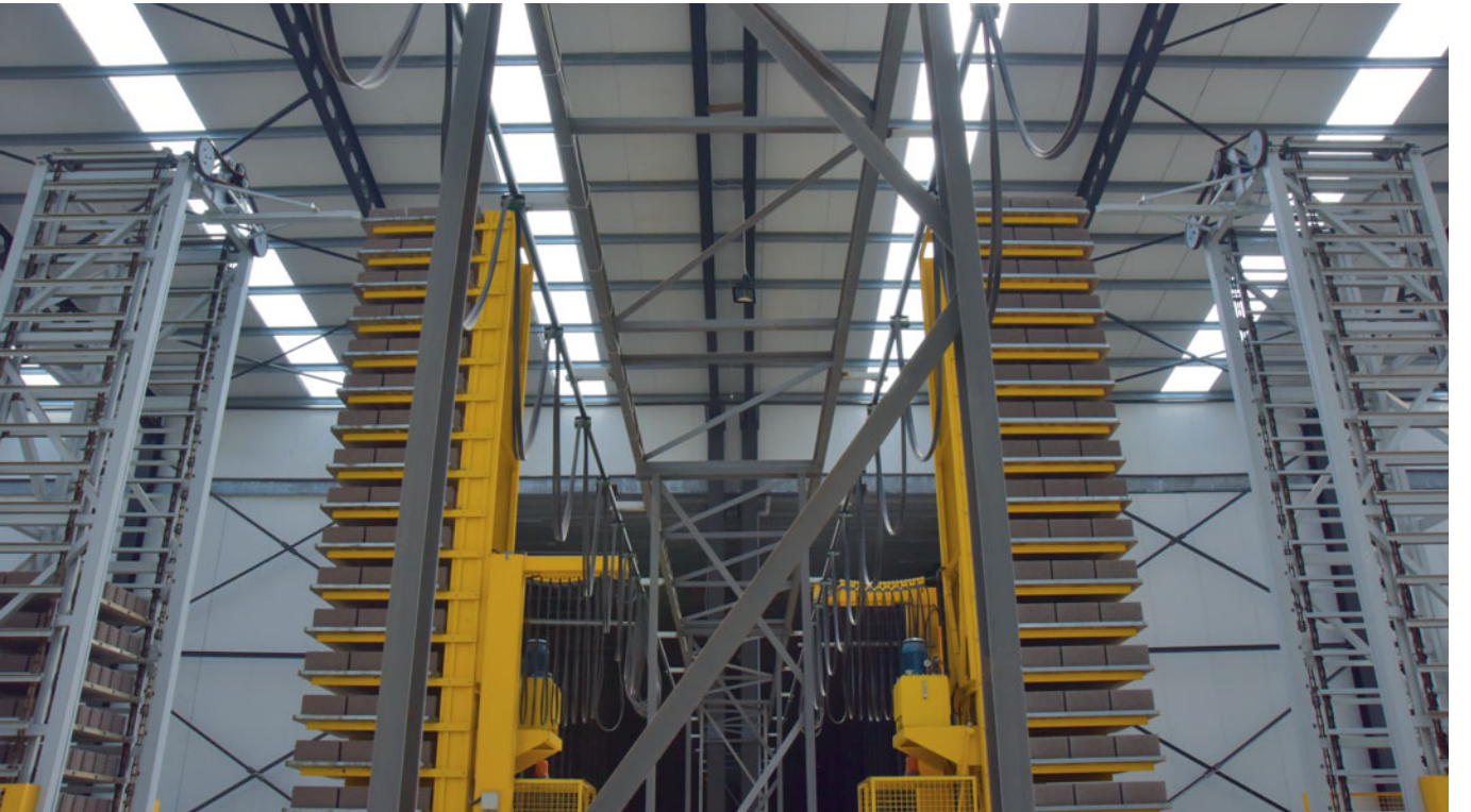
Blokları kurutma odalarına taşımak için 20 katlı otomatik araç grubu.
