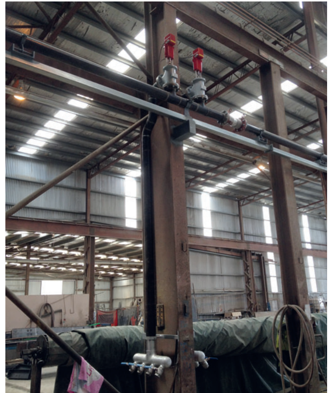
Şekil 4: Otomatik kumandalı buhar vanilleri ilgili kürleştirme bölgeleri için buhar miktarını ve arzu edilen beton sıcaklığını düzenliyor.
